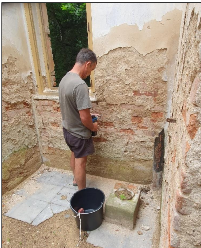
Foto 19: Zkouška pevnosti malty, oblast F
