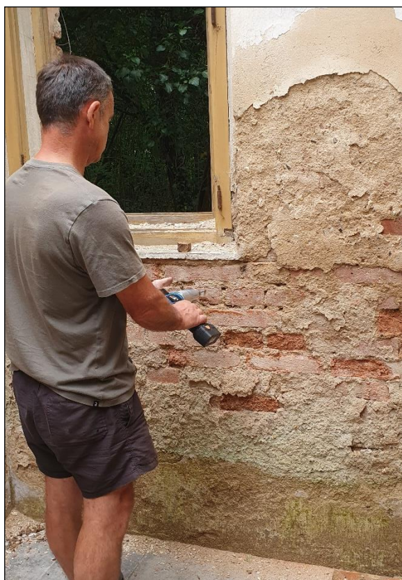
Foto 18: Zkouška pevnosti cihel, oblast F
