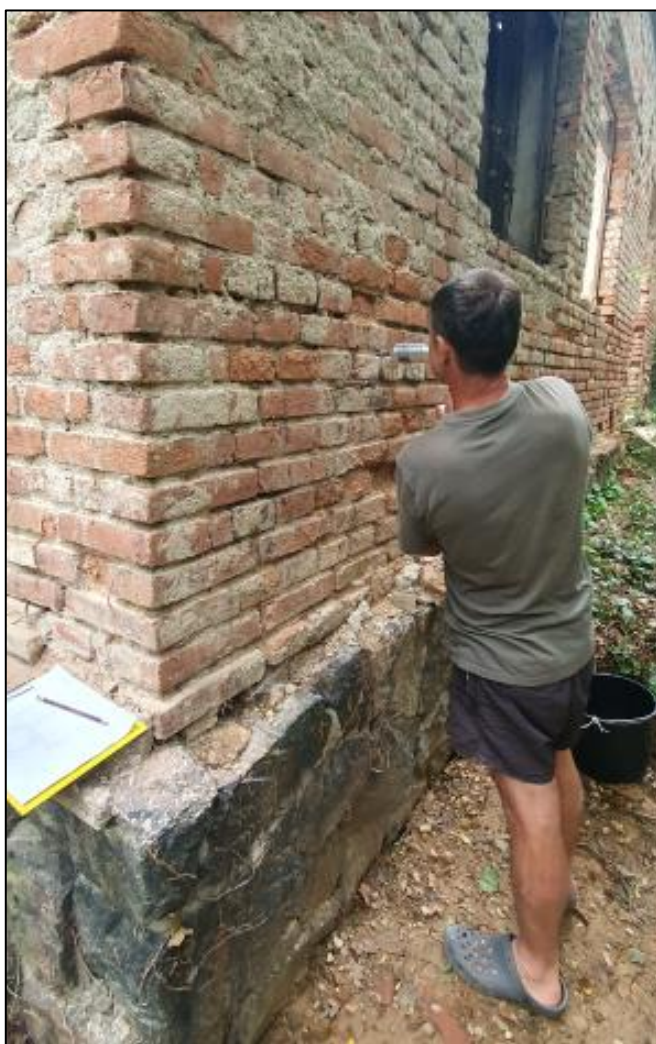
Foto 20: Zkouška pevnosti malty, oblast D
